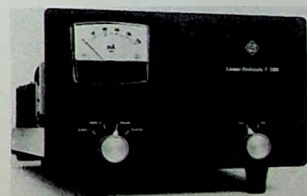
Linear-Endstufe von W. Fischer (DJ 3 AT) für das 2-m-Band mit 300 W Output bei SSB
